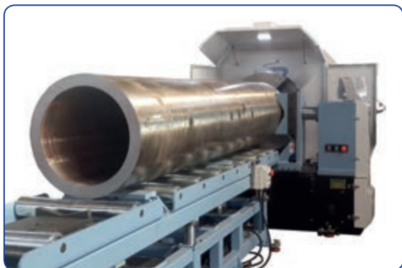
SPBM (Máy Vát Mép Ống đặt tại xưởng)
